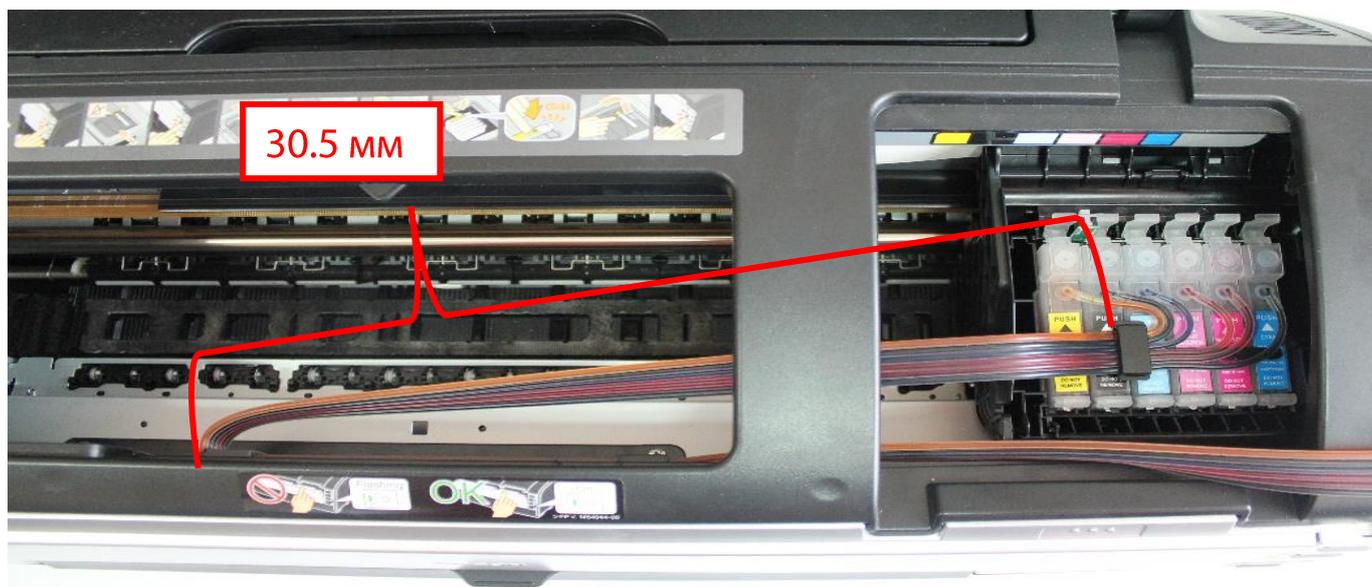
9. Закрепите крепление-липучку с защёлкой на корпусе принтера и зафиксируйте в нем шлейф, как показано на рисунке.
