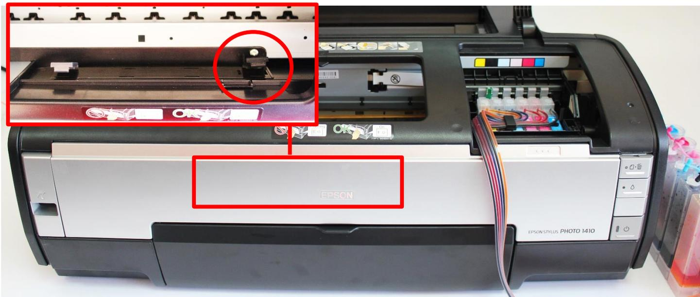
8. Заведите шлейф в «крепление планку» таким образом, чтобы жёлтая трубка была сверху. Отрегулируйте длину от защёлки на картриджах до второй защёлки на планке которая составляет 30.5 мм. Шлейф не должен быть излишне натянутым, и излишне перегнутым возле второй защёлки на планке.
