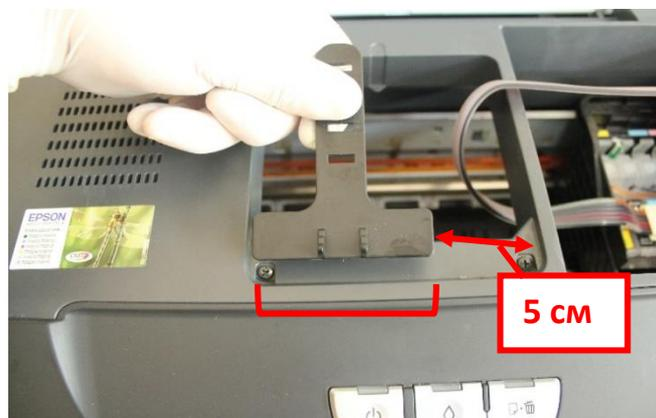
10. Закрепите шлейф с помощью защёлки, отрегулируете длину шлейфа. Несколько раз передвиньте каретку принтера из крайнего левого положения в крайнее правое.
