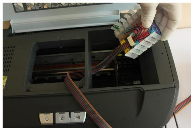
8. Выведите каретку в позицию замены картриджей. Вставьте картриджи СНПЧ в каретку. При правильной установке закроются защелки на картриджах, и вы услышите щелчок.
