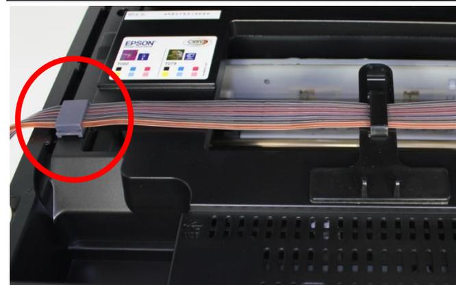
14. С помощью поролона заблокируйте датчик открытой крышки, как показано на рисунке.
