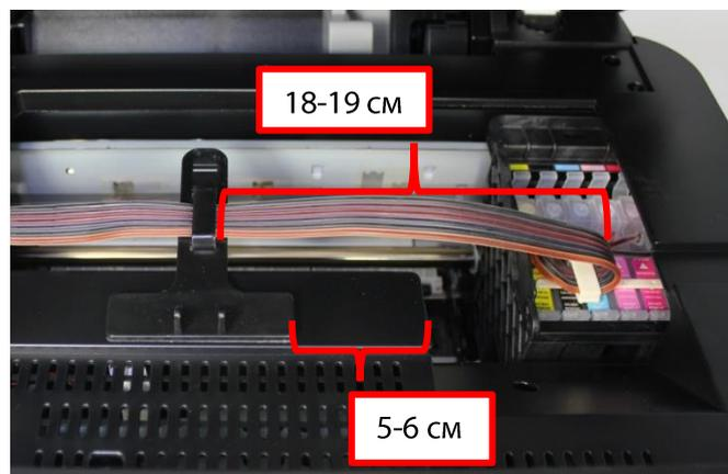
11. Закрепите крепление-липучку с защелкой на корпусе принтера и зафиксируйте в нем шлейф, как показано на рисунке.
