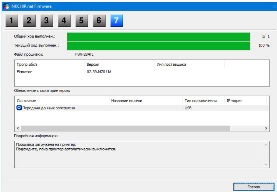
На этом этапе безчиповая прошивка будет загружена в принтер. Прогресс прошивки будет отображаться на дисплее. О завершении процесса загрузки прошивки в принтер будет свидетельствовать перезагрузка принтера.
